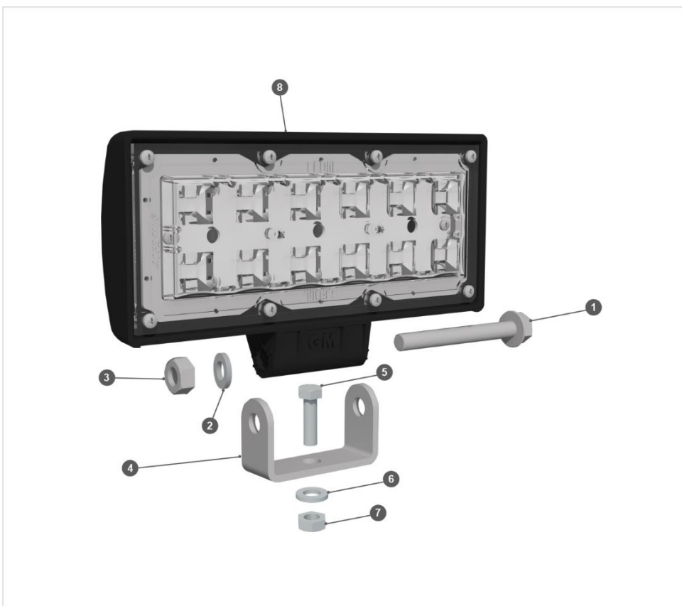
Рисунок 1. Схема монтажа фары GM-TRAC.
